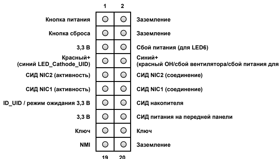
Рис. 4-1. Контакты JF1 на панели управления
